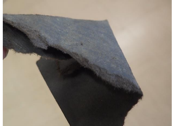
Kuva 7. mPAH 2, bitumipaperi sisältää erittäin suuria pitoisuuksia PAH-yhdisteitä, käsiteltävä vaarallisenajätteenä
