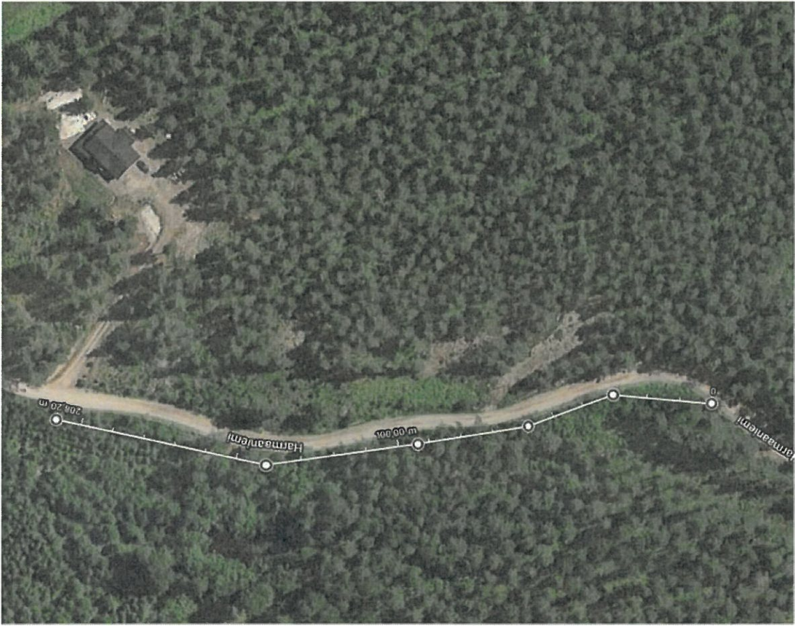
3 UUDEN OJAN KAIVAMINEN, 210 m
