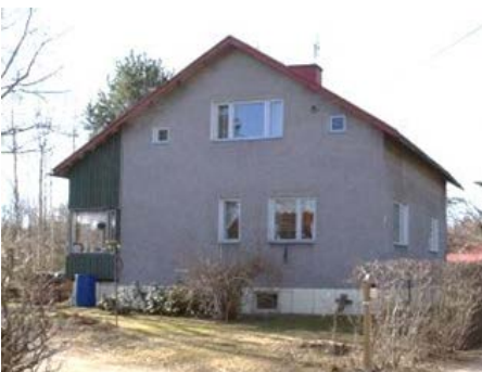
5. 1950-l. Aikakaudella maalattiin ikkunakarmi usein erivärisiksi kuin vaalea puite. Myös räystäänaluslaudoitus maalattiin usein eri värillä kuin seinät ja kattotuolien päät.
