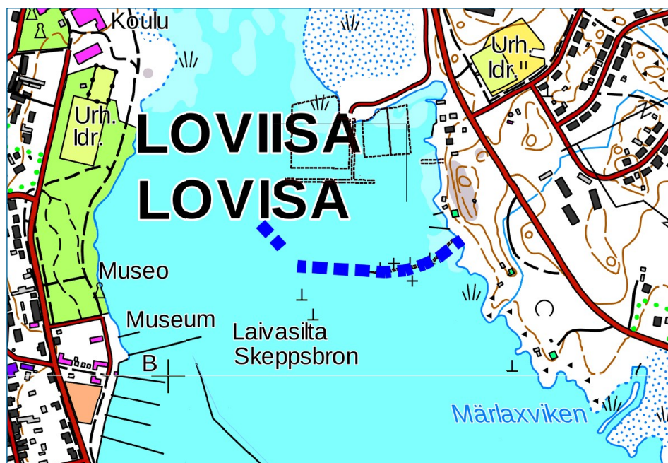
Bild 6. Objektet skyddas med en fast vågbrytare (skyddsalternativ 1). Vågbrytaren visas som streckad linje i blått.
