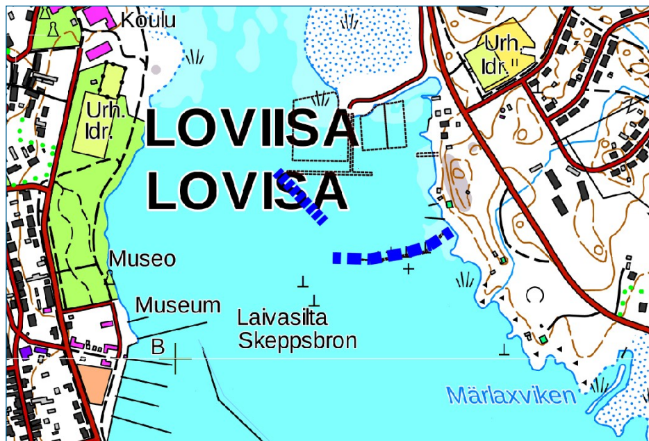
Bild 8. Objektet skyddas med en kombination av fast vågbrytare och flytande pontonvågdämpare (skyddsalternativ 3). Vågbrytaren visas som streckad linje i blått och vågdämparen som tät streckad linje i blått.
