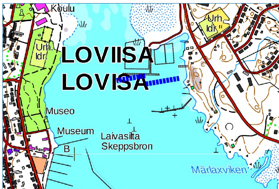
Bild 7. Objektet skyddas med pontonvågdämpare (skyddsalternativ 2). Vågdämparen visas som tätt streckad linje i blått.
