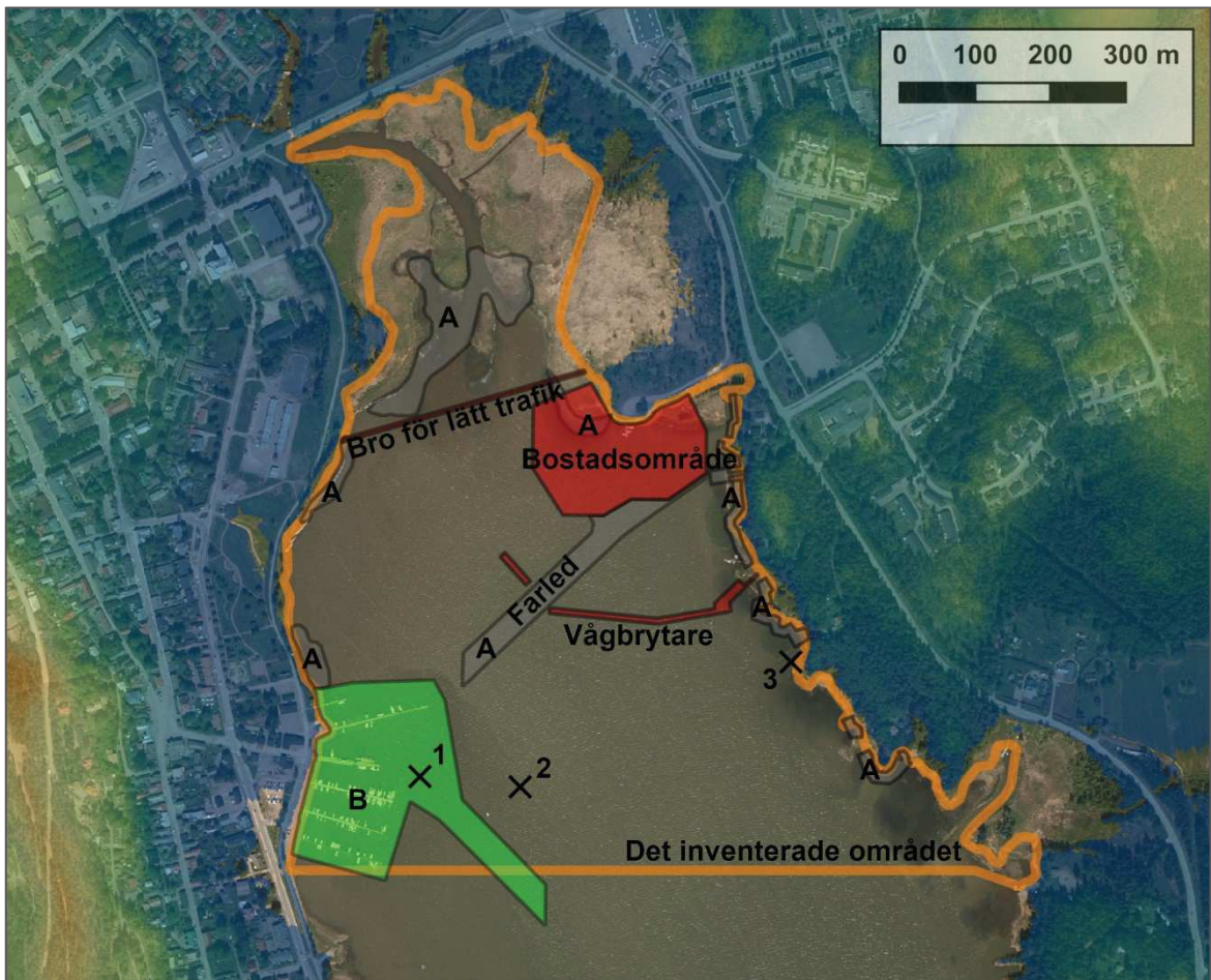
Karta 4. En generalkarta över områdets detaljplan. De numrerade kruxen är kända fornlämningar under vattenytan (obs. nr 3 är på kartan belägen 30 m för långt österut); A anger områden som eventuellt skall muddras och B den redan muddrade farleden till gästhamnen. Baserar sig på Lantmäteriverkets terränghöjdmmodell och ortofoto, 4/2020. Kartan skapad av: Aki Hakonen.
