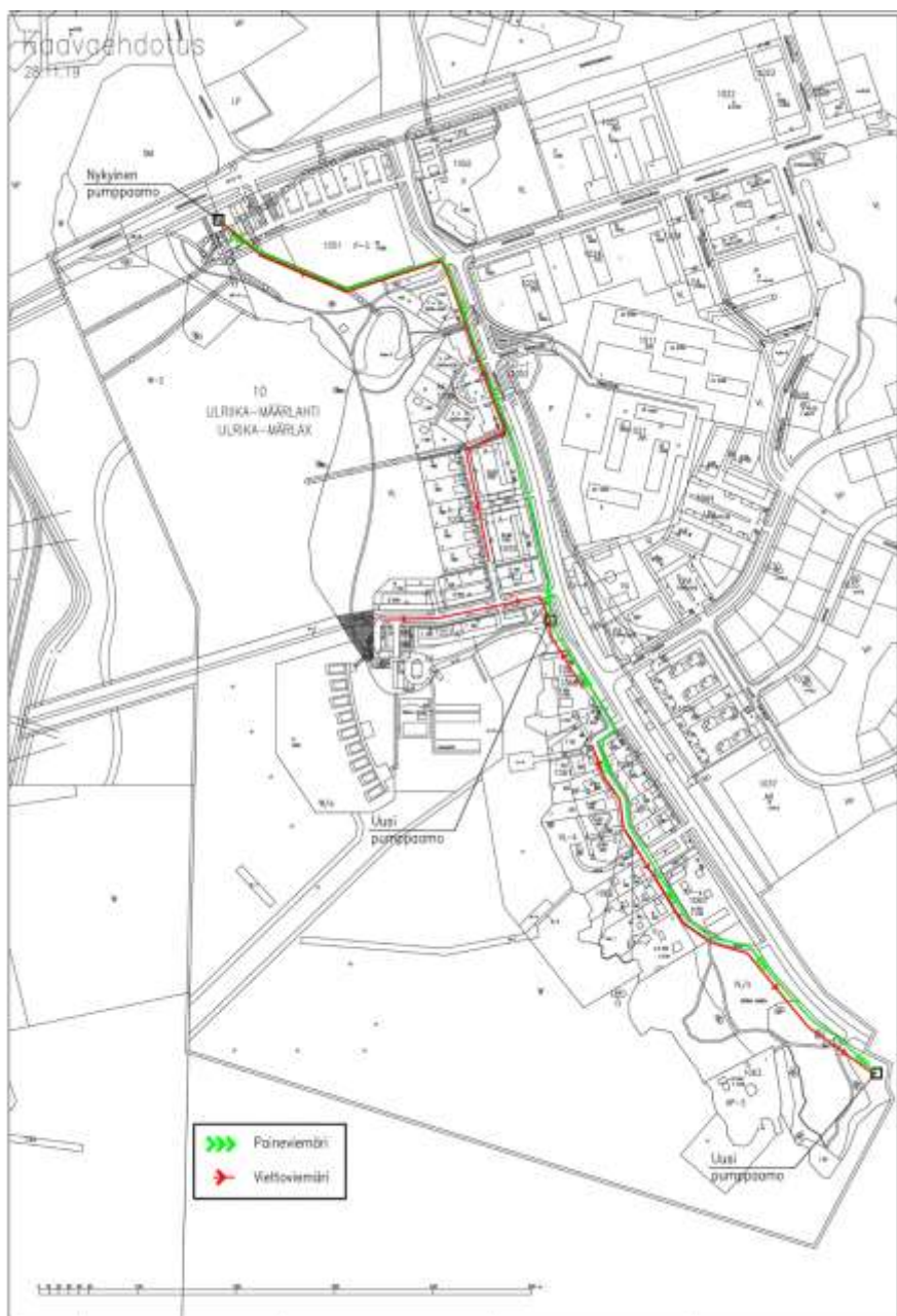
Principerna för avledning av avloppsvatten.
