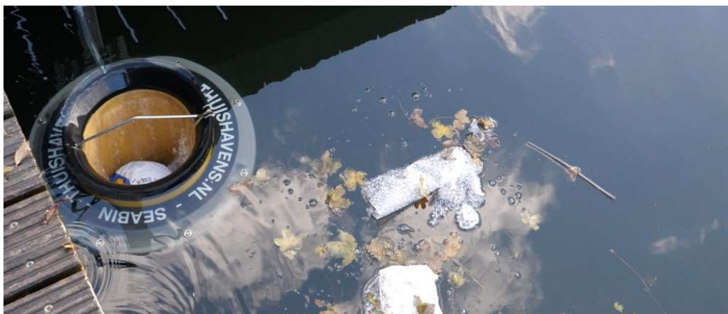
Bild 27. Seabin vattenskräpsamlare (Seabin, https://seabinproject.com/the-seabin-v5/ ).
