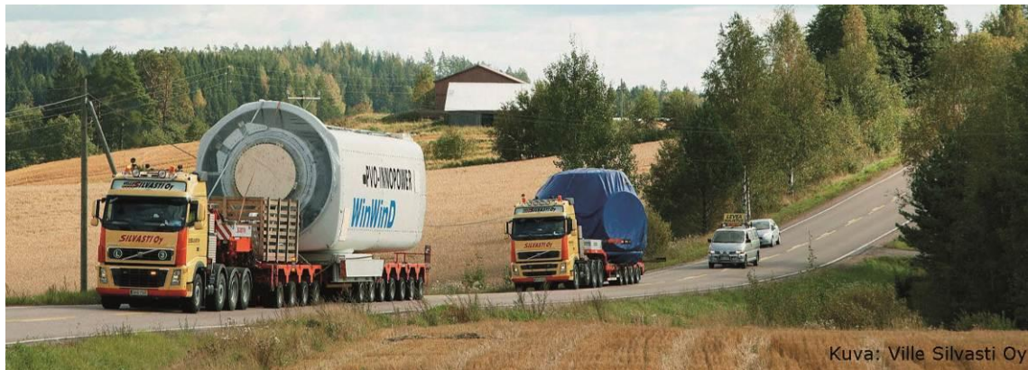
Figur 6-3. Transport av delar (maskinhus och nav) till vindkraftverk.
