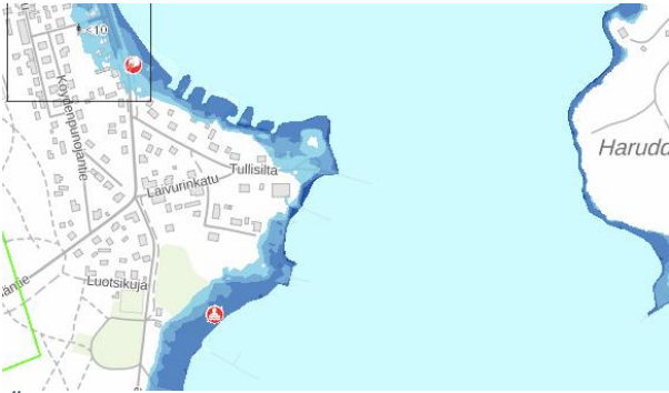
Översvämningskarta över en exceptionell översvämning som beräknas återkomma en gång per 100 år (Översvämningscentret, översvämningskarttjänsten)
