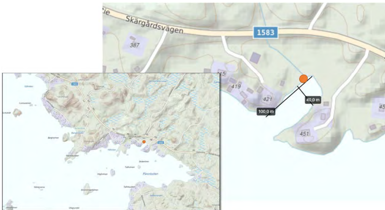
Kuva 7. Maakaatopaikalta vapautuvien vesien purku Pärönbotteniin ja vastaanottavan poukaman mittasuhteet.
