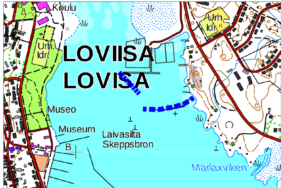
Kuva 8. Kohteen suojaaminen kiinteän aallonmurtajan ja kelluvan ponttoniaallonvaimentimen yhdistelmällä (suojausvaihtoehto 3). Aallonmurtaja on esitetty sinisellä katkoviivalla ja aallonvaimennin sinisellä tiheällä katkoviivalla.
